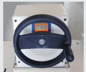
MTBS 2103 F ▶ Bedienung des Hinteranschlags von der Maschinenfront über Handrad und Zählwerk
