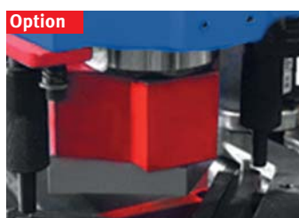
► Optionales V-Auslinkmesser ab HPS 45S erhältlich
