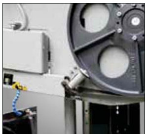
Angetriebene Späneräubbürste zur Reinigung und Instandhaltung des Sägebandes
