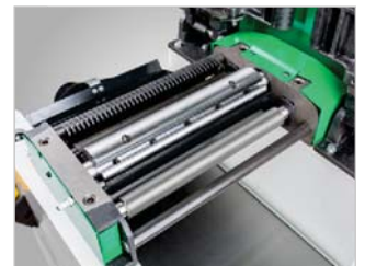
Verstellung der Spanabnahme über Bedienhebel
