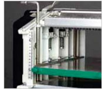
Die durch Federn gelagerten Einzugswalzen verhindern Eindrücke auf dem Holz. Der Dickentisch wird auf vier Säulen geführt.
