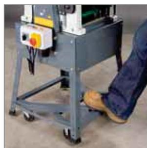
Das serienmäßige Fahrwerk mit zwei Lenkrollen ermöglicht einen leichten Transport. Zum Bewegen der Maschine wird einfach auf den Fahrwerksbügel getreten, wodurch die Rollen nach unten gebracht werden. Über einen Federbügel kehrt das Fahrwerk in die Ausgangsstellung zurück.
