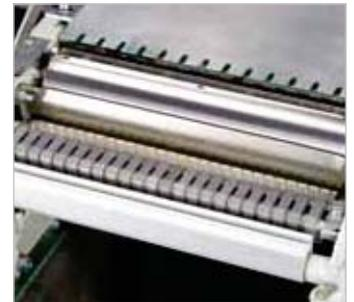
Automatischer, gleichmäßiger Vorschub mit Rückschlagsicherung. Die verzahnte Einzugswalze gewährt einen konstanten Holzeinzug.
