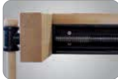
Massive Linearführung an der Hinterzange
