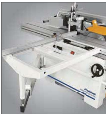
Serienmäßig mit ausziehbarem Alu-Teleskop-Ablänganschlag und Profi-Klappanschlägen. Stufenlos verstellbar für Gehrungsschnitte von 0 bis 45°.
