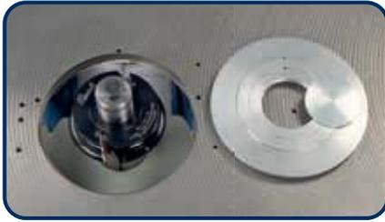
Eine große Frästisch-Öffnung ermöglicht auch den Einsatz von größeren Abplattfräsern sowie Zapfenschneid- und Schlitzwerkzeugen über und unter dem Tisch.
