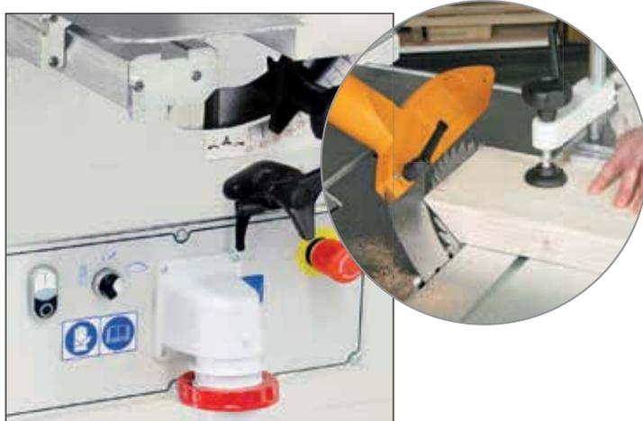
Manuelle Höhen- und Schrägverstellung des Sägeaggregats über Sterngriff. Genaue Positionierung anhand einer Skala.
