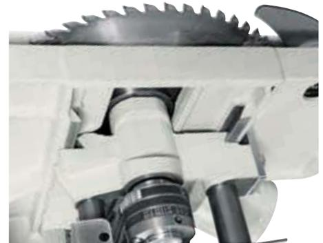
Die Höhenverstellung des Sägeaggregats
