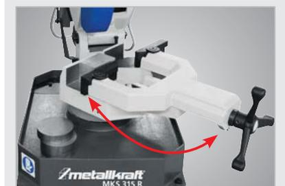
▶ Schnellspann-Schraubstock 45° nach links und 45° nach rechts schwenkbar
