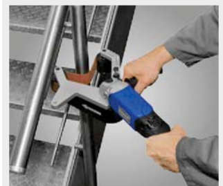
Besonders geeignet zum Bearbeiten von bereits montierten Geländern
