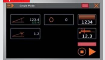
► **Optionale Steuerung Schneider NC1**, Biegewinkel, Hinteranschlag, und Oberwangenöffnung über Touchscreen, motorischer Hinteranschlag mit Anschlagfingern, 15-1000mm, Speichern von Kantfolgen möglich
