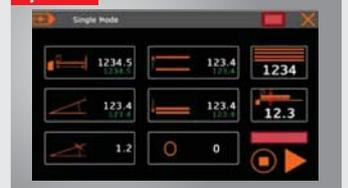
► **Optionale Steuerung Schneider NC2**, Dreiachssteuerung für digitale Winkeleingabe, Eingabe der Hinteranschlagposition und Position der Oberwangenöffnung mit der Möglichkeit Kantfolgen zu speichern, motorischer Hinteranschlag mit Anschlagfingern, Verfahrbereich 15-1000mm
