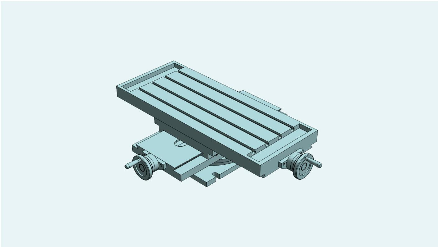
Drehbare Koordinatentische mit 2 Achsen, für mechanische Anwendungen bei denen ausser der Kontrolle des X-Y Verfahrweges noch eine Drehbewegung des Tisches von 180° benötigt wird. Alle Elemente sind in Grauguss GG25 stabilisiert. Millimeter Regeln XY. Chrom matt Nonius, mit Null-Einstellrad. Trapezspindle mit einstellbare Mutter. Standard-Blockierung -M6.
