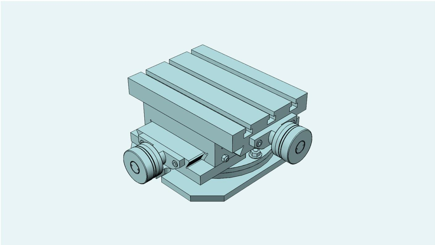
Drehbare Koordinatentische mit 2 Achsen, für mechanische Anwendungen bei denen ausser der Kontrolle des X-Y Verfahrweges noch eine Drehbewegung des Tisches von 180° benötigt wird. Alle Elemente sind in Grauguss GG25 stabilisiert. Millimeter Regeln XY. Chrom matt Nonius, mit Null-Einstellrad. Dreiecks Spindle mit einstellbare Mutter. Standard-Blockierung -M6.
