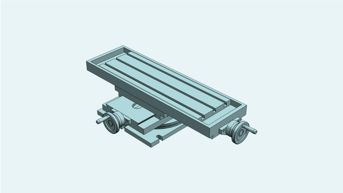
Drehbare Koordinatentische mit 2 Achsen, für mechanische Anwendungen bei denen ausser der Kontrolle des X-Y Verfahrweges noch eine Drehbewegung des Tisches von 180° benötigt wird. Alle Elemente sind in Grauguss GG25 stabilisiert. Millimeter Regeln XY. Chrom matt Nonius, mit Null-Einstellrad. Trapezspindel mit einstellbare Mutter. Standard-Blockierung -M6.
