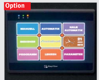
► Option: NC-Steuerung mit Touchscreen und Teach-In-Funktion
